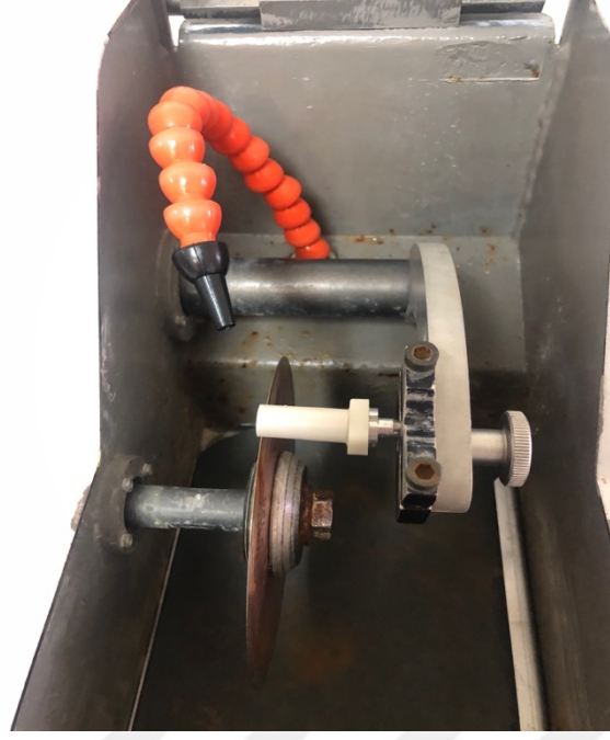
Şekil 3.9 Elmas kesici diskle PEKK silindir blokların kesilerek disklerin elde edilişi.
