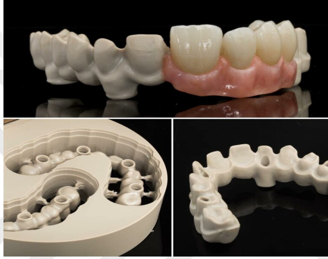
Şekil 2.22 PEKK alt yapıların CAD/CAM ile üretimi [131].
