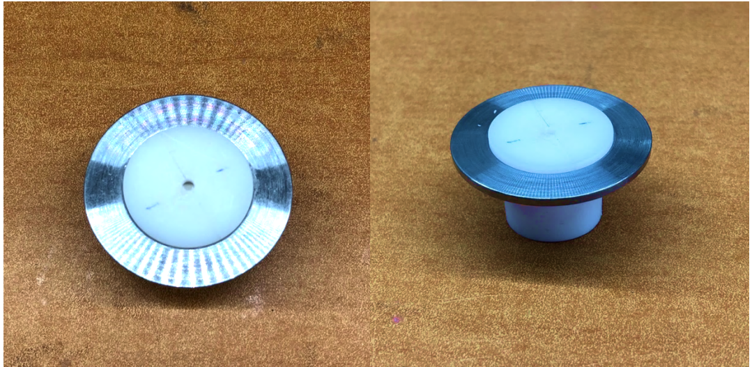
Şekil 3.26 Pembe kompozitin uygulanmasında standartizasyonu saėlama amacıyla kullanılan teflon moldlar.
