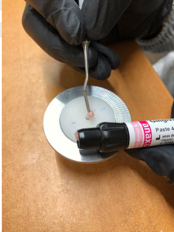
Şekil 3.28 Teflon mold yardımı ile PEKK diskler Anaxgum Gingiva Paste Light Pink pembe kompozit uygulanması.
