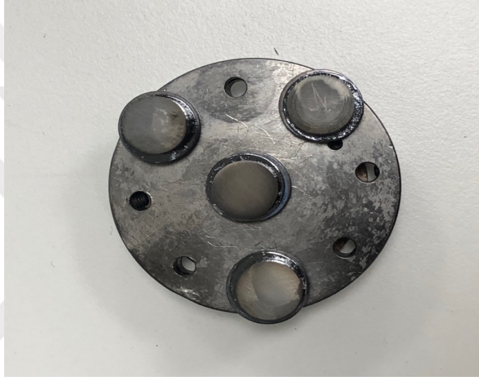
Şekil 3.21 Örneklerin SEM analizi için altın kaplanması.
