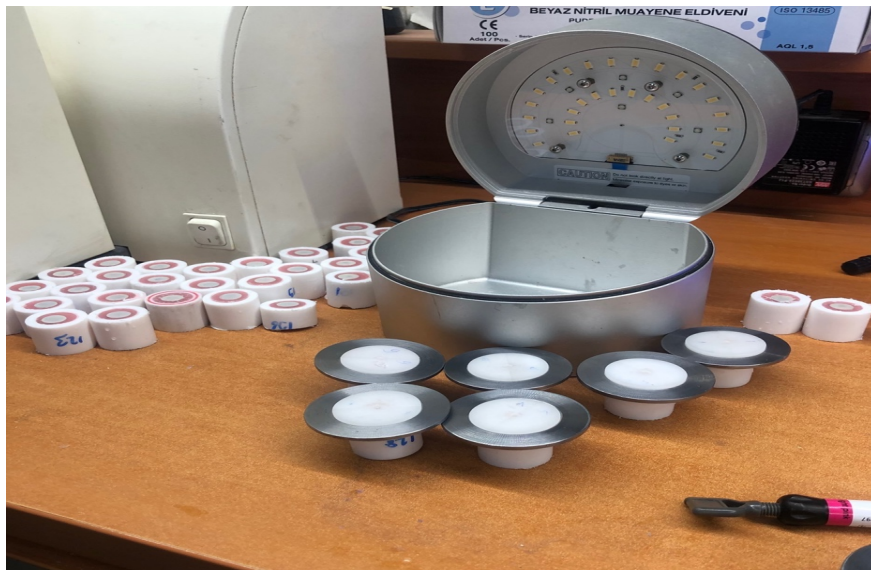
Şekil 3.30 Örneklerin Anaxdent Light Box ile polimerize edilmesi.
