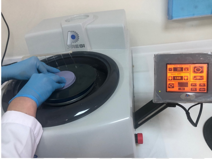
Şekil 3.11 PEKK disklerin silikon karbit kağıtlarla zımparalanması.
