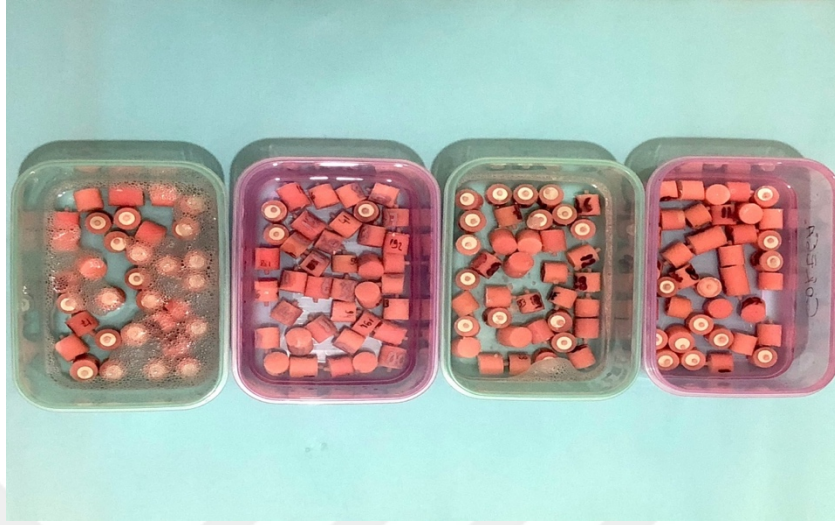
Şekil 3.36 Örneklerin temizleme solüsyonlarında ve distile suda bekletilmesi.
