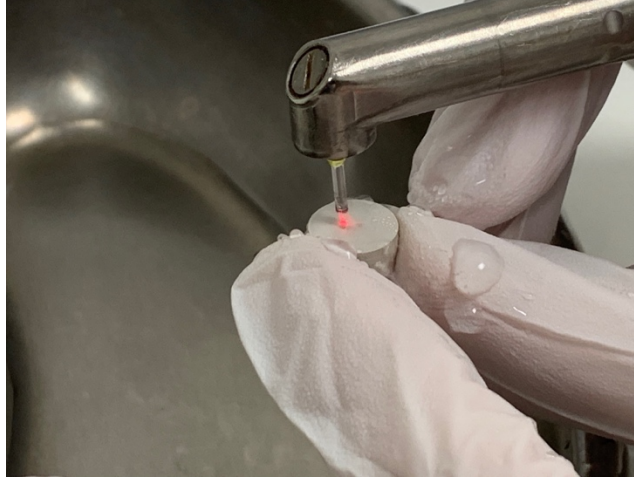
Şekil 3.17 Örneklere Er-YAG lazerin uygulanışı.
