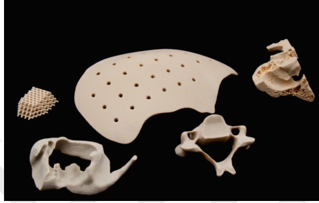
Şekil 2.13 PEKK polimerinin ortopedik implant örnekleri [125].
