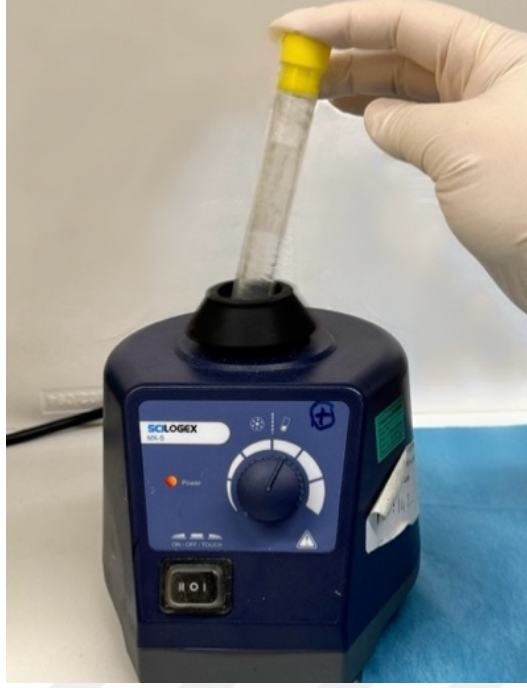
Şekil 3.9. Taşıma besiyeri (VMG II) içerisindeki örneğin karıştırıldığı vorteks cihazı (SCILOGEX MX-S Vortex Mixer).
