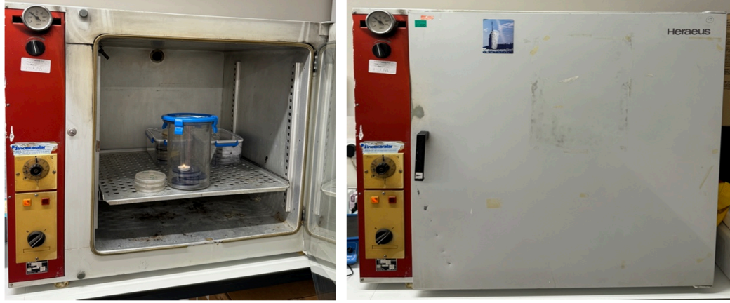
Şekil 3.11. Mum söndürme kavanozu ve inkübasyon sırasında bakterilerin üremesi için gerekli ortam sıcaklığını sağlayan etüv cihazı (Heraeus- D6450).
