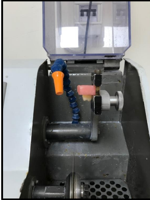
Őekil 3.3: Akrilik blokların kesme cihazına yerleŐtirilmesi.
