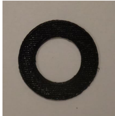
Şekil 3.12 Disk şeklindeki örneklerin hazırlanması için fleksi materyalinden üretilen kalıplar.
