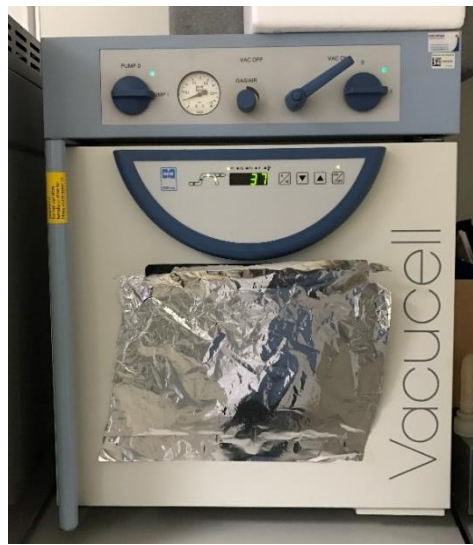
Şekil 3.15 Örneklerin sabit kütle ağırlıklarına ulaşabilmeleri için kullanılan vakumlu etüv (VacuCell, MMM, Almanya).
