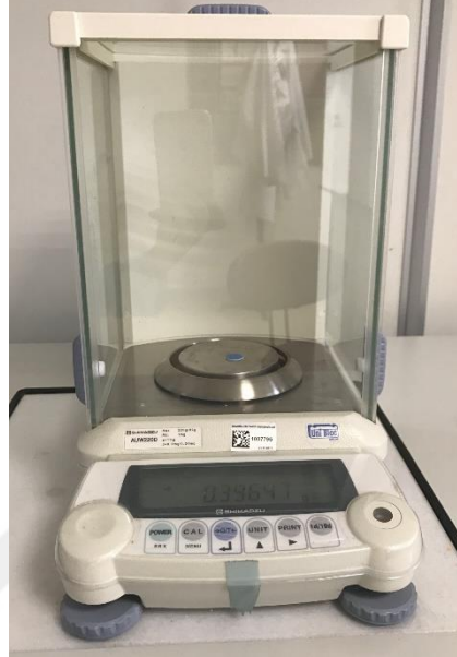
Şekil 3.16 Elektronik analitik ölçüm yapan hassas tartı (Shimadzu AUW220D, Japonya).
