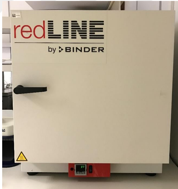
Şekil 3.18 Örneklerin muhafaza edildiği etüv (Redline by Binder, FD115, Almanya).
