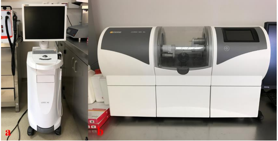
Şekil 3.1 a) Seramik diş örneklerinin elde edilmesinde kullanılan tarama cihazı (Cerec Omnicam; Sirona, Bensheim, Almanya) b) Frezeleme ve aşındırma cihazı (Cerec MC XL; Sirona, Bensheim, Almanya).
