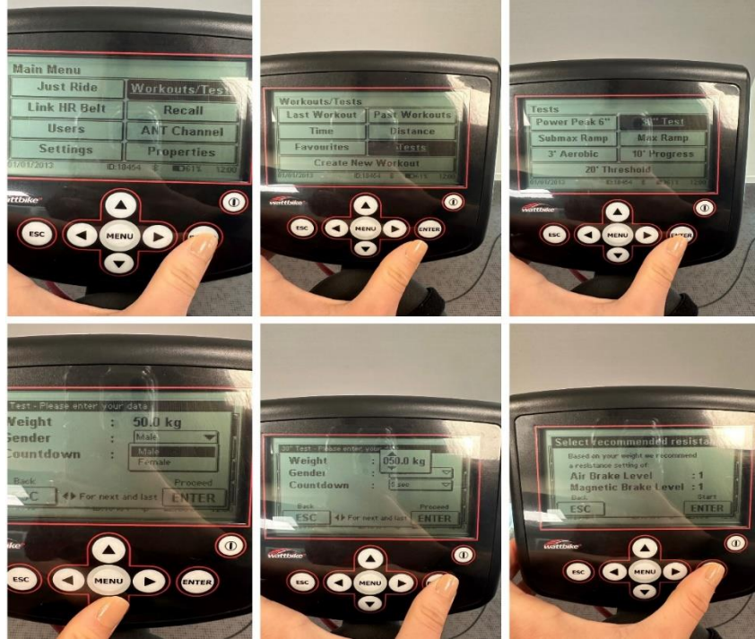
Şekil 3.3 Cihazın ayarlanma aşamaları
