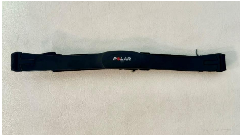
Şekil 3.5 Test sırasında kalp tepe atımını ölçen göğüs bandı
