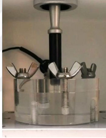
Şekil 3.9 : SM-x ve Nc-x jel örneklerinin Tekstür analiz cihazı ile tek eksenli biyo-yapışma bağ kuvveti ölçümlerinin gerçekleştirilmesi.
