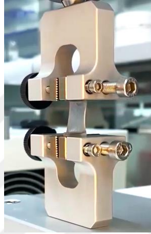
Şekil 3.8 : SM- x ve Nc- x jel örneklerinin Tekstür analiz cihazı ile tek eksenli uzama ölçümlerinin gerçekleştirilmesi.
