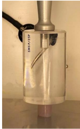
Şekil 3.7 : SM-x ve Nc-x jel örneklerinin Tekstür analiz cihazı ile tek eksenli sıkıştırma ölçümlerinin gerçekleştirilmesi.
