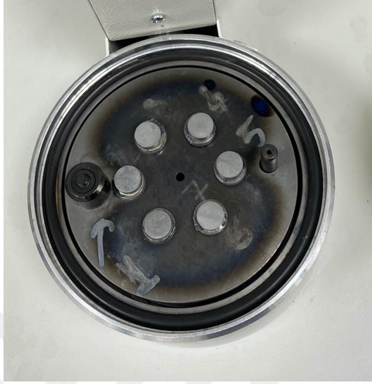
Şekil 3.19: Örneklerin SEM analizi için altın kaplanması.
