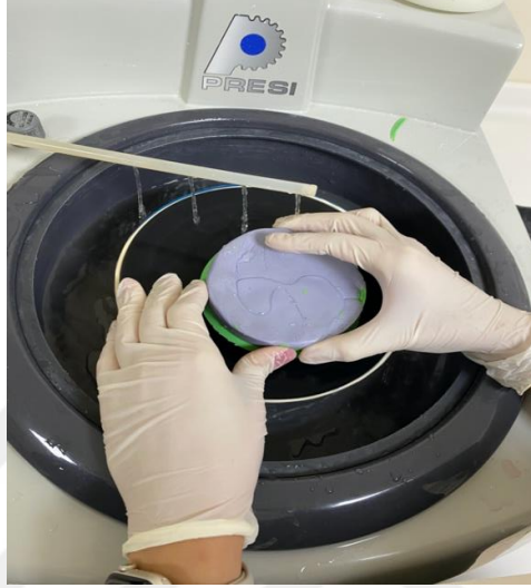
Şekil 3.11: PEEK ve PEKK disklerin su soğutması altında zımparalanması.
