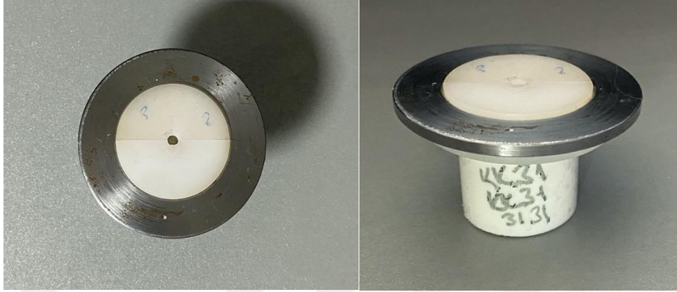
Şekil 3.25: Pembe kompozitin uygulanmasında standartizasyonu sağlama amacıyla kullanılan teflon moldlar.
