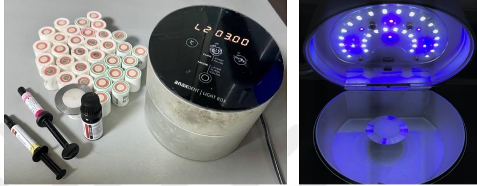
Şekil 3.29: Kompozit bağlanan örneğin teflon kalıpla beraber polimerizasyon cihazına yerleştirilmesi ve kullanılan program modu.
