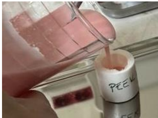
Şekil 3.22: Örneklerin akriliğe gömülmesi.
