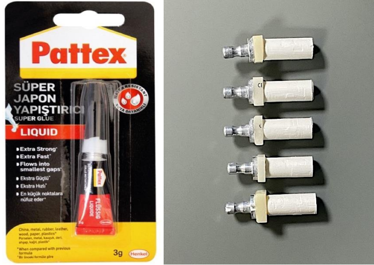
Şekil 3.7: PEEK ve PEKK silindir blokların sabitlenmesi.
