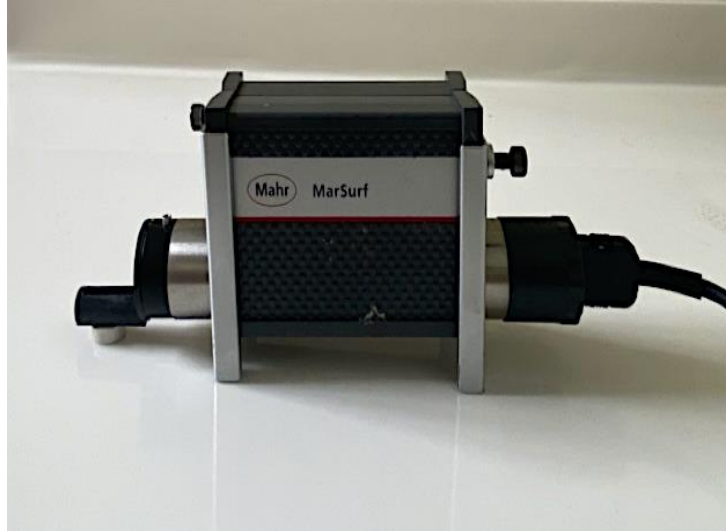
Şekil 3.13: Yüzey pürüzlülük değerlerinin ölçülmesi.
