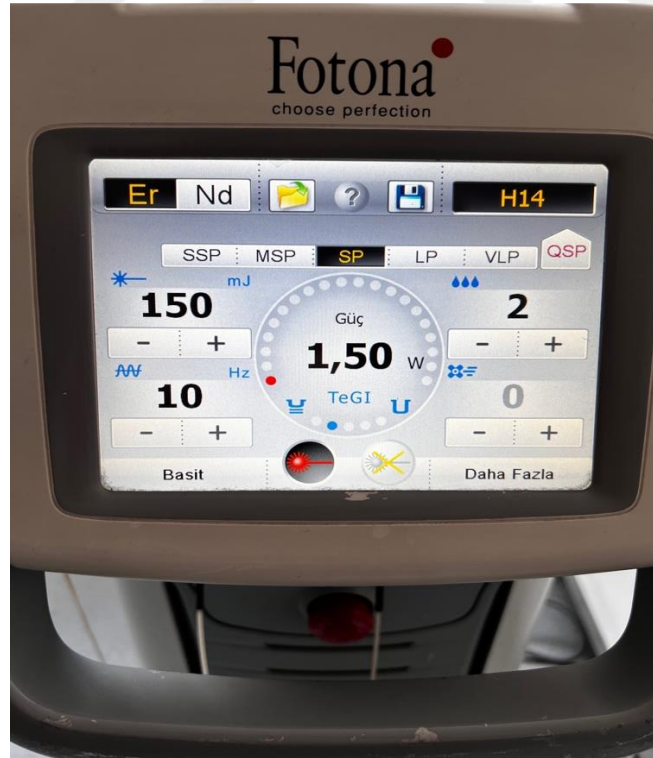
Şekil 3.14: Çalışmamızda kullanılan Er:YAG lazer cihazı ve parametreleri.
