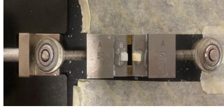
Şekil 3.16: Zirkonya-dentin çubuğun mikrogerilim bağlanma dayanım testi sonucunda başarısızlığa uğramış hali.
