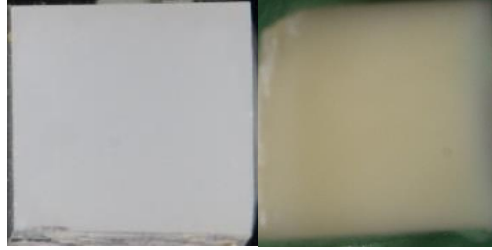
Şekil 4.8: Örneğin zirkonya esaslı seramik yüzeyinde zirkonya-siman adeziv başarısızlık (sol) ve diş yüzeyinde dentin-siman adeziv başarısızlık(sağ).
