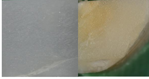
Şekil 4.10: Örneğin zirkonya esaslı seramik simantasyon yüzeyinde karma başarısızlık (sol) ve diş yüzeyinde yapıştırma simanı koheziv başarısızlık (sağ).
