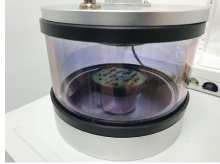
Şekil 3.8: Diş örneklerinin SEM kaplama cihazında altın palladyum ile kaplanması
