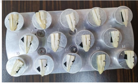
Şekil 3.8: Diş örneklerinin SEM kaplama cihazında altın palladyum ile kaplanması
