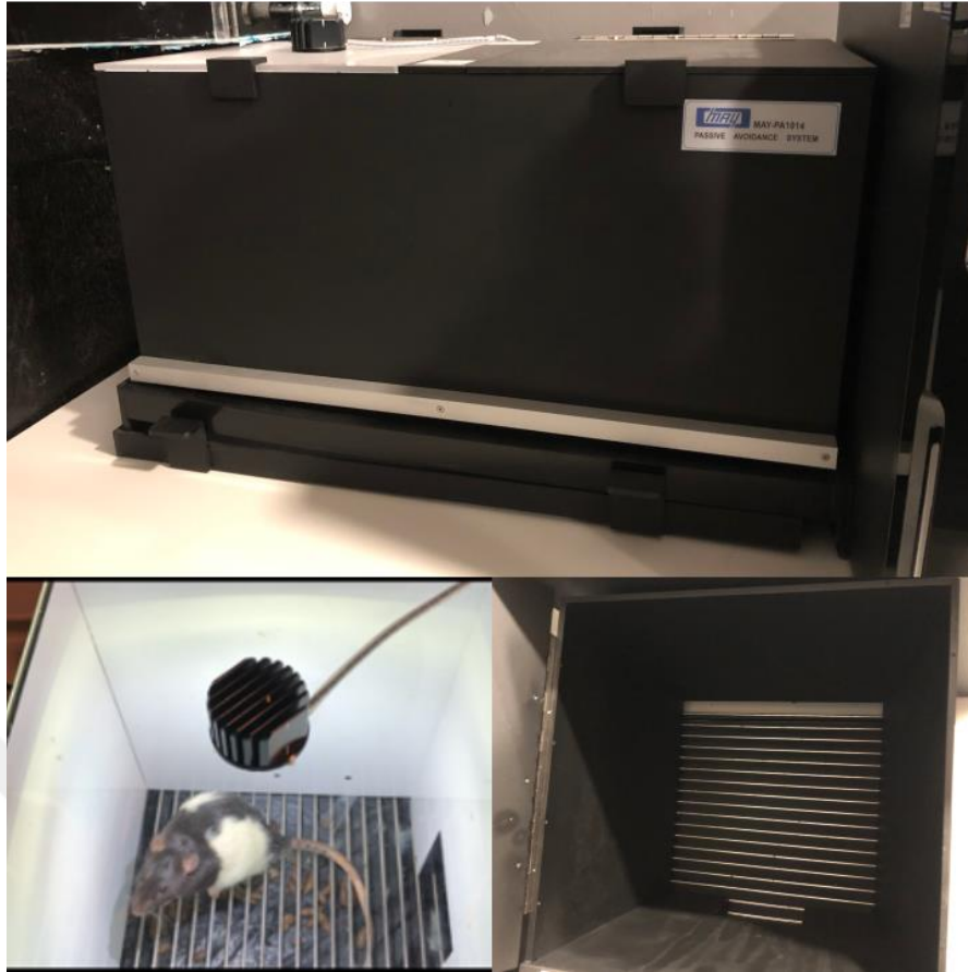
Şekil 3.5: Pasif sakınma düzeneği
