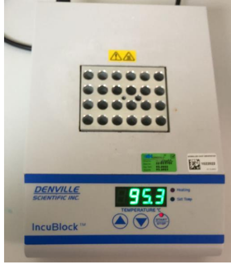
Şekil 3.22: Proteinlerin ısıtılarak denatüre edilmesinde kullanılan inkübasyon cihazı
