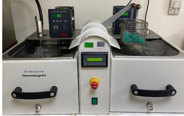
Şekil 3.10: Termal siklus test cihazı (SD Mechatronik Termocycler, Almanya)
