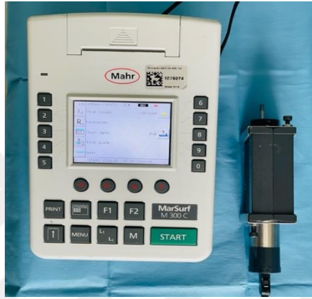
Şekil 3.5: Çalışmada kullanılan profilometre cihazı
