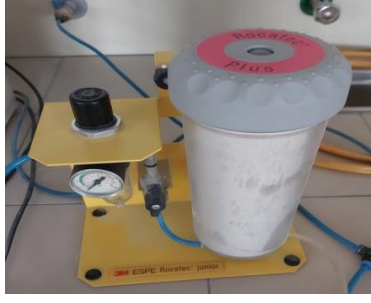
Şekil 3.8: Çalışmada kullanılan Rocatec Junior cihazı ve Cojet kumu
