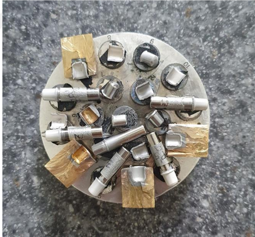
Şekil 3.54: Örneklerin üzerinin altın ile kaplanması.
