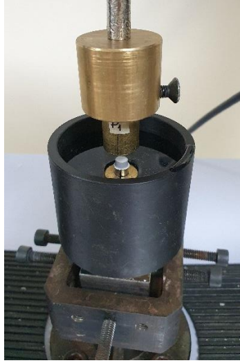
Şekil 3.45: Deney düzeneğinin yapay tükürük içerisindeki görünümü.
