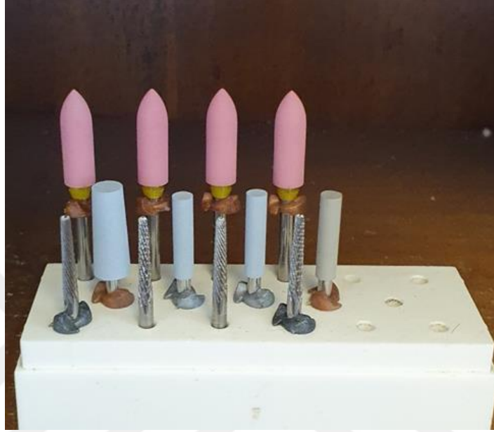
Şekil 3.7: Zirkonya cilası için kullanılan cila lastikleri.
