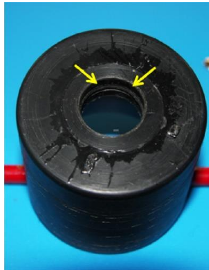
Şekil 3.48: Yapay tükürük haznesinin ara parçaya bağlanmasını sağlayan o-ring.
