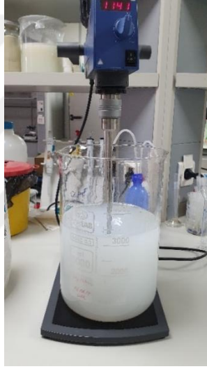
Şekil 3.50: Yapay tükürüğün hazırlanması.
