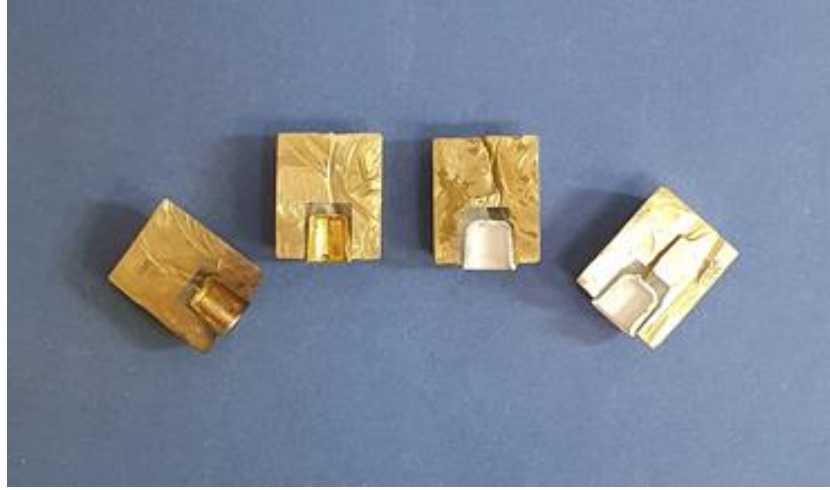
Şekil 3.51: Sekonder kuronların pirinç ara parçalarla birlikte ikiye ayrılması.
