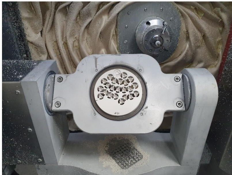
Şekil 3.23: Kuronların CAM ünitesinde kazınması.
