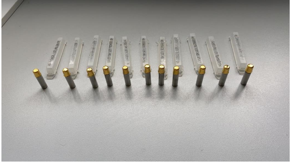
Şekil 3.17: Elektroşekillendirme ile üretilen sekonder kuronlar.
