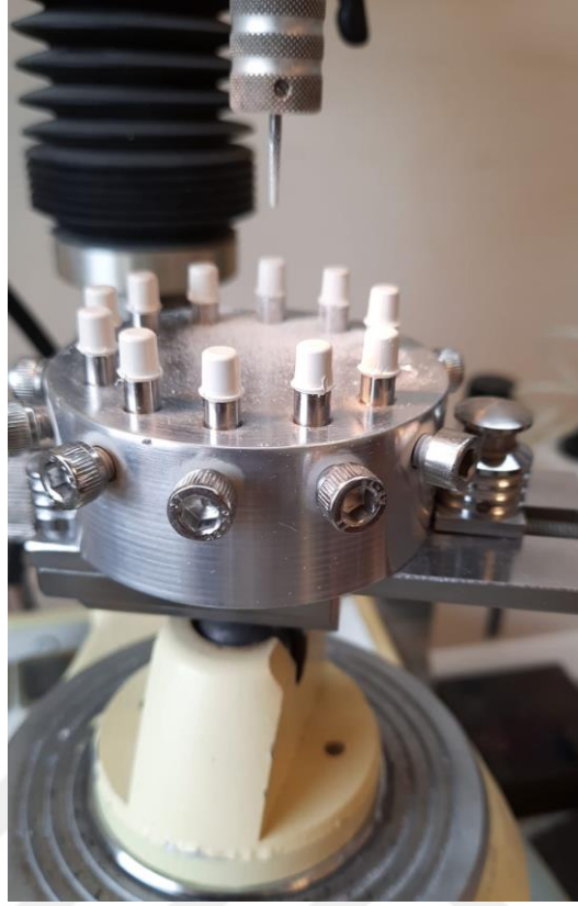
Şekil 3.30: PEEK primer kuronların freze edilmesi.
