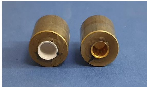
Şekil 3.38: Sekonder kuronların pirinç ara parçalara simante edilmiş hali.
