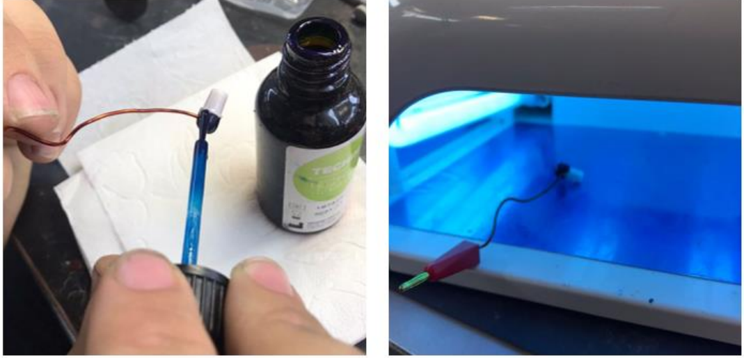
Şekil 3.12: Altın kaplanması istenmeyen yerlerin lak ile kaplanması ve polimerizasyonu.
