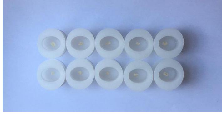
Şekil 3.3: Mine kesitlerinin silikon kalıplara (FixiForm, 25 mm çap, Struers, Almanya) yerleştirilmesi
