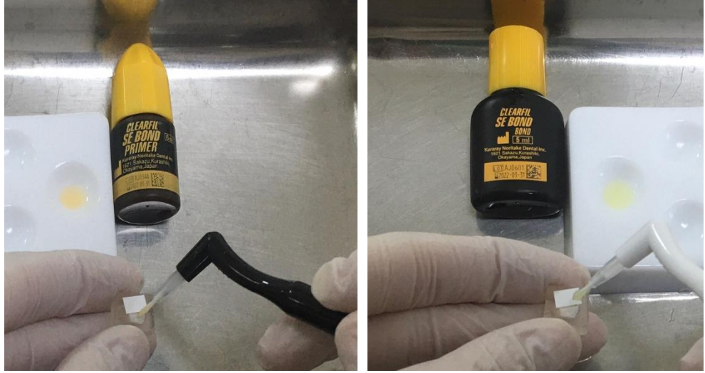
Şekil 3.17: Primer ve bond uygulaması
