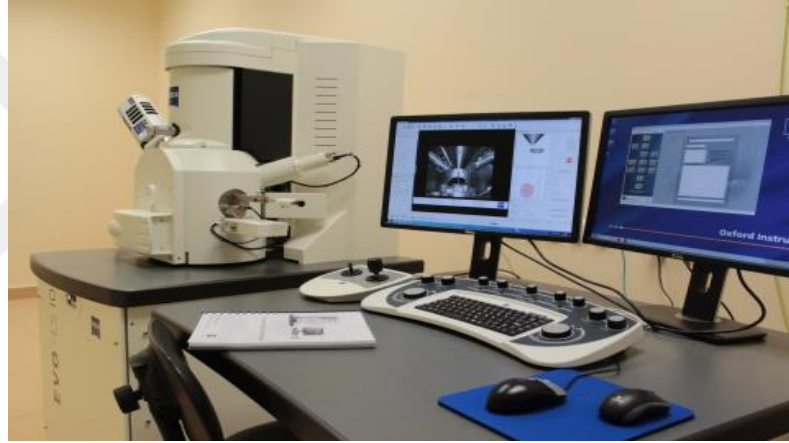
Şekil 3.21: SEM cihazı (EVO LS10, Zeiss, Oberkochen, Almanya)
