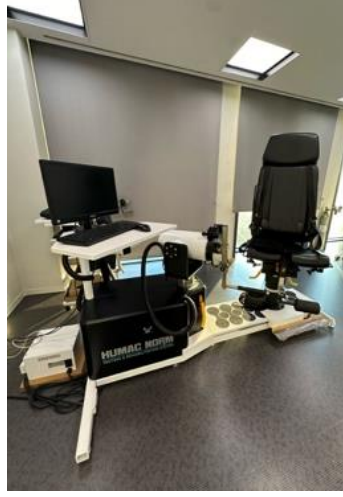
Şekil 11: CSMI (CYBEX) Humac norm izokinetik test ve egzersiz sistemi cihazı.
