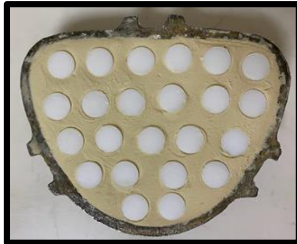
Şekil 3.5: Alçı içine gömülmüş teflon ana modeller
