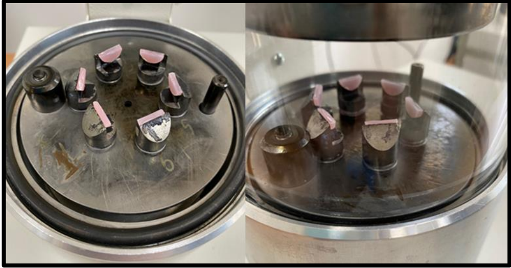
Şekil 3.36: Örneklerin altın kaplama cihazına yerleştirilmesi
