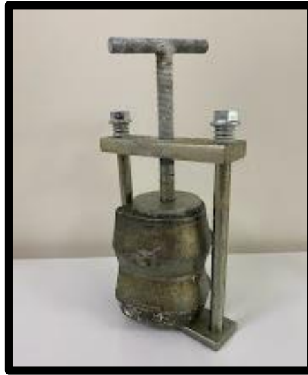
Şekil 3.9: Yaylı brit ile muflaların sıkıştırılması
