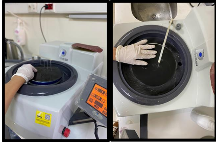
Şekil 3.11: Akrilik disklerin zımparalanması
