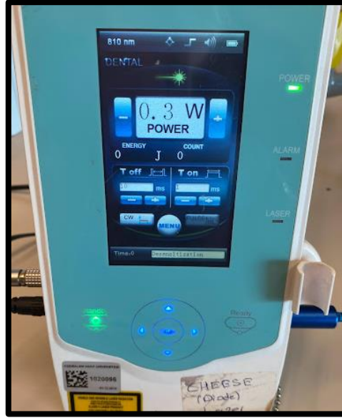
Şekil 3.23: Lazer cihazı ve uygulanan lazer parametreleri
