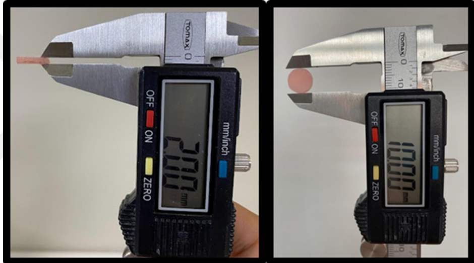
Şekil 3.12: Akrilik disklerin boyutlarının elektronik kumpasla ölçülmesi
