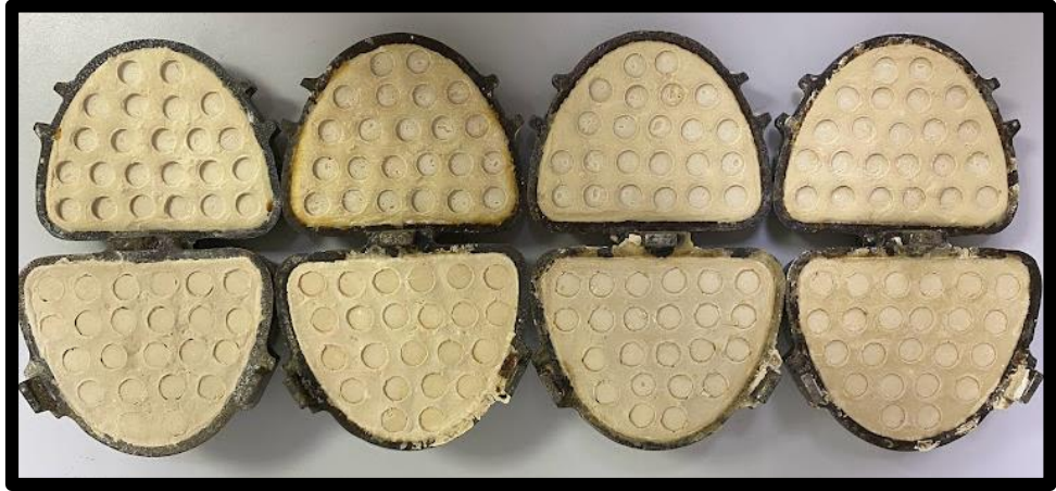
Şekil 3.6: Muflalarda akrilik diskler için oluşturulmuş boşluklar
