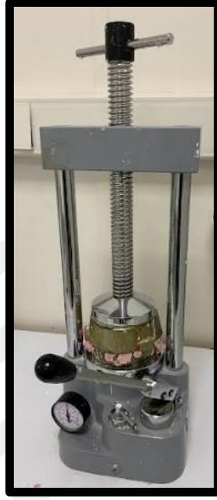
Şekil 3.8: Preste bekletilen mufla
