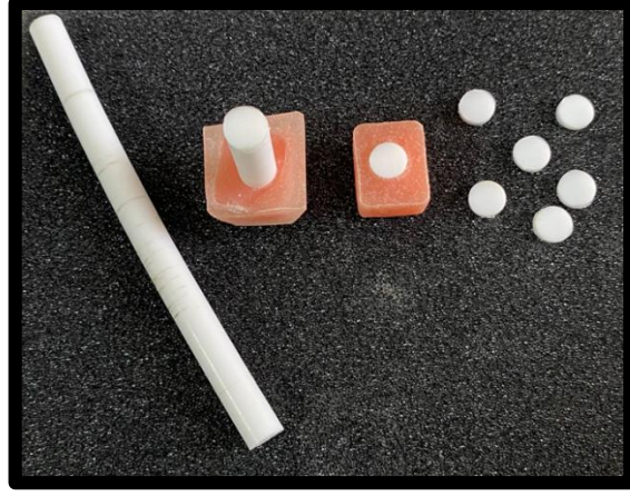
Şekil 3.2: Teflon silindirden hazırlanan kalıp diskler
