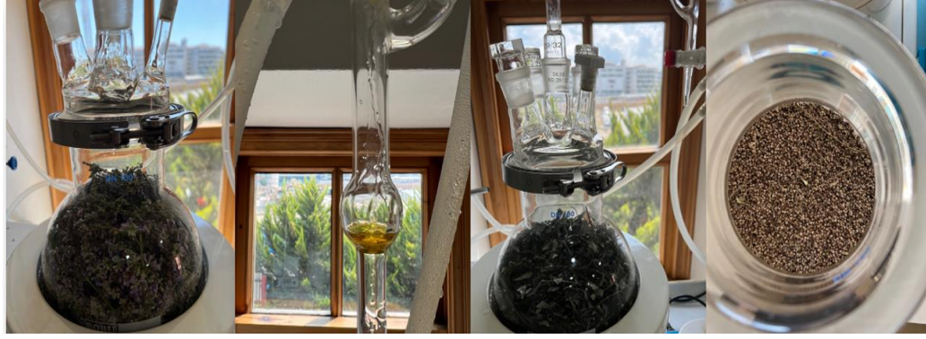
Şekil 5.1: V. agnus-castus bitkisinden uçucu yağ eldesi.
