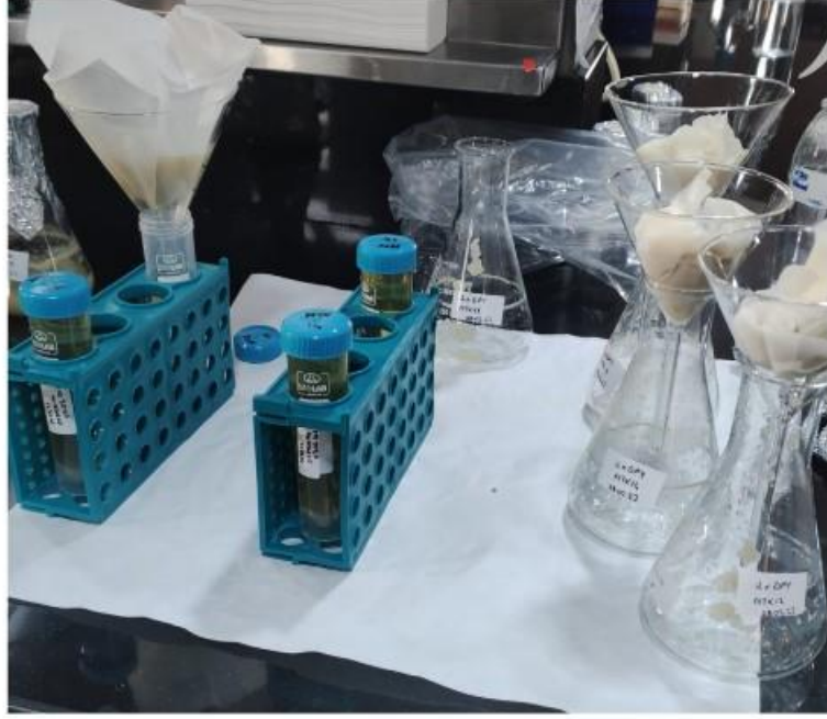
Şekil 17 : Ekspresyon sonrası Aspergillus'ların süzülmesi.
