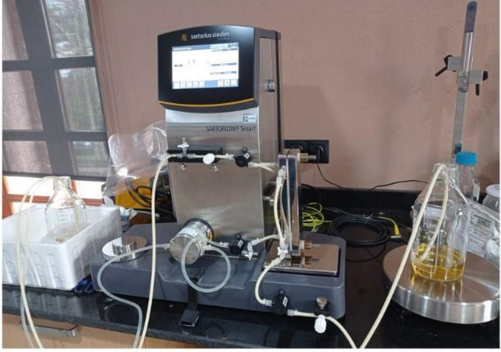
Şekil 18 : Çapraz Akışlı Filtrasyon cihazından örneklerin geçirilmesi.
