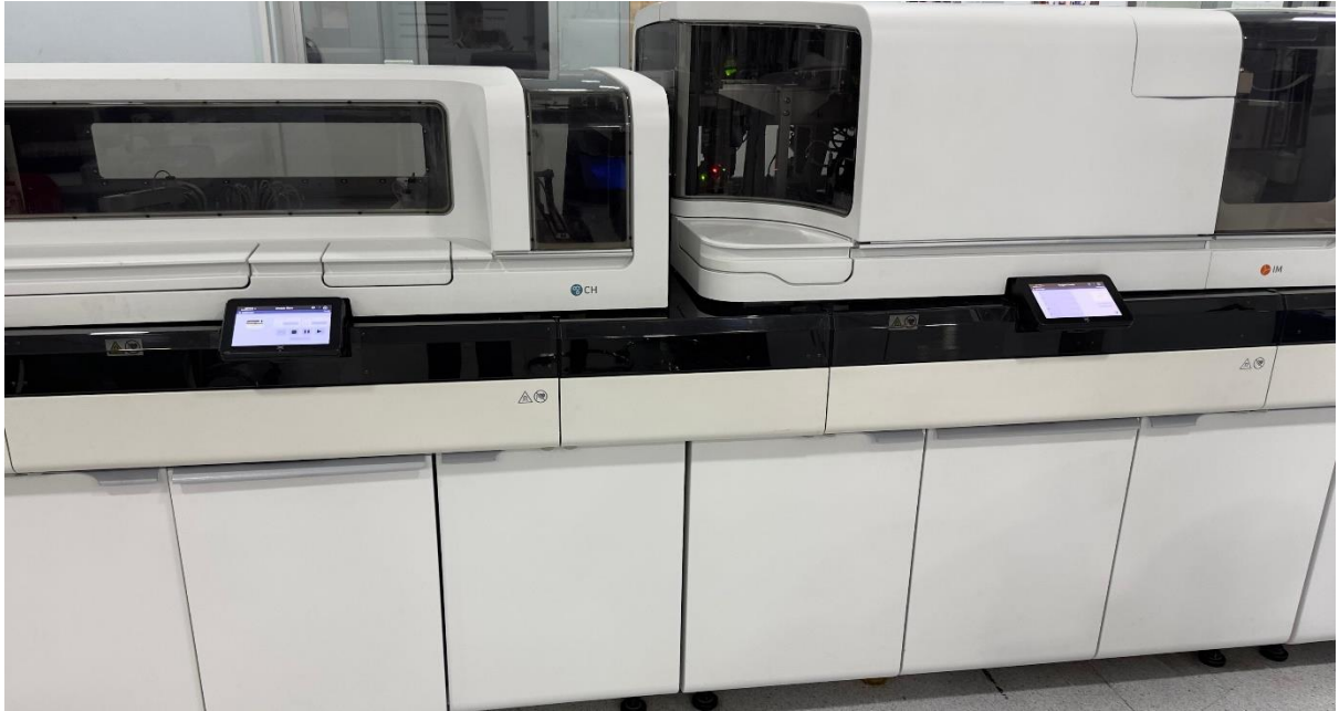
Resim 2.2. Modern bir tıbbi biyokimya laboratuvarındaki bir otoanalizör sistemi.
