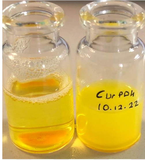
Şekil 4.12: Nano enkapsülasyon ile kurkumin sulu ortamda tamamen dağılırken serbest kurkumin çok az çözünür ve gözle görülebilen parçacıklar oluşturur.
