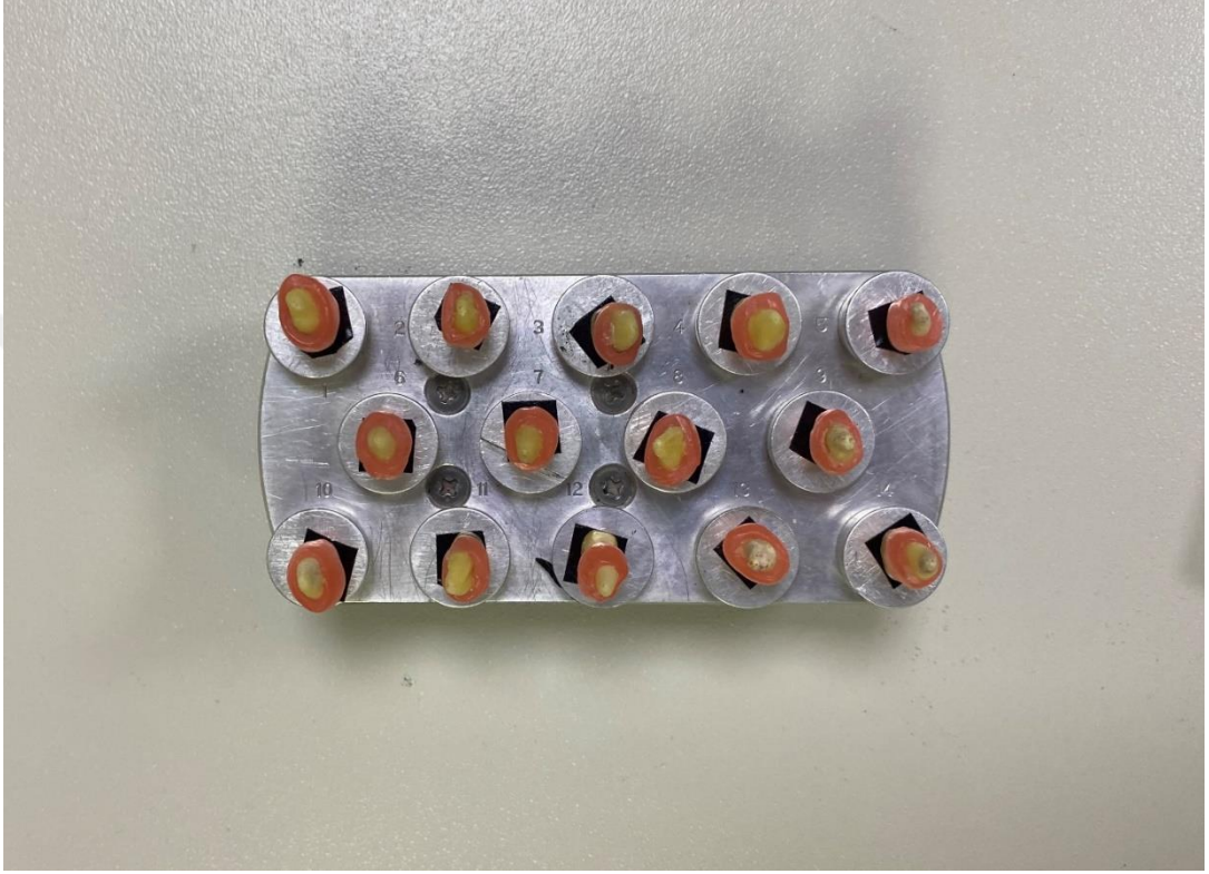
Şekil 3.3.13 SEM görüntülemesi öncesi dişlerin platforma yerleştirilmesi
