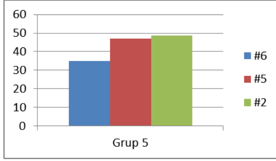
Şekil 4.61 : 4 adet standart implant (lateral kesici dişler #2 düz açılı, ikinci küçük azı #5, dişleri hizasında distale açılı (30 derece)) 2 adet ekstra kısa implant düz yerleştirilerek (birinci büyük azı dişler #6 hizasında) kantileversiz planlanan grubun yorulma değerleri.
