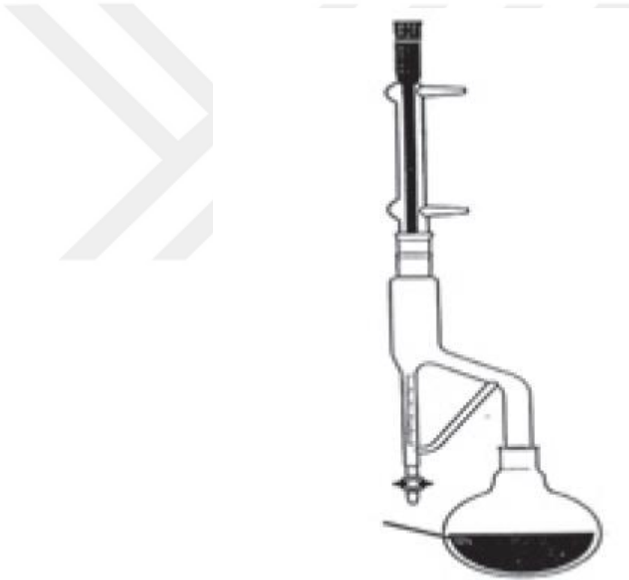
Şekil 2.16 : Clevenger tipi laboratuvar ölçekli hidrodestilasyon aparatı.
