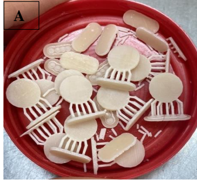
Şekil 3. 4: A) Tij bağlantısı kesilmemiş örnekler B) Tij bağlantısının kesilmesi ve kıl fırça ile örnek yüzeylerinin cilalanması
