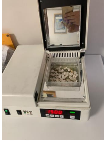
Şekil 3. 3: Otofash G171-6 (NK Optik, Baierbrunn, Germany) kütleme cihazında örneklerin kürlenmesi
