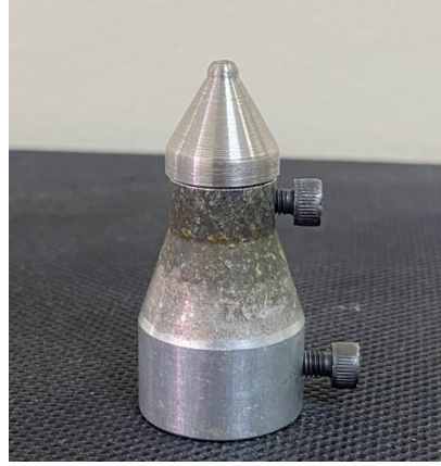
Şekil 3. 18: Antagonist olarak kullanılan paslanmaz çelik hemisfer
