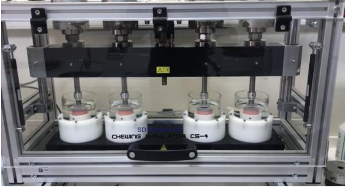
Şekil 3.12 Mekanik siklus test cihazı (SD Mechatronik Chewing Simulator CS-4, Almanya).
