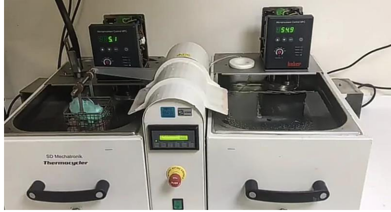
Şekil 3.10 Termal siklus test cihazı (SD Mechatronik Termocycler, Almanya).
