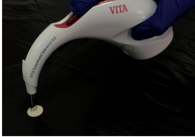
Şekil 3.9 Örneklerin spektrofotometre ile translusensisinin ölçülmesi (VITA Easyshade Advance 4.0 (VITA Zahnfabrik BAD Sackingen, Almanya)).
