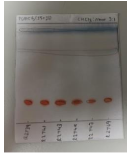
Şekil 4.20: Annphenone'un vanilin-sülfürik asit reaktifi ile yakıldıktan sonra elde edilen ince tabaka kromatografisi.
