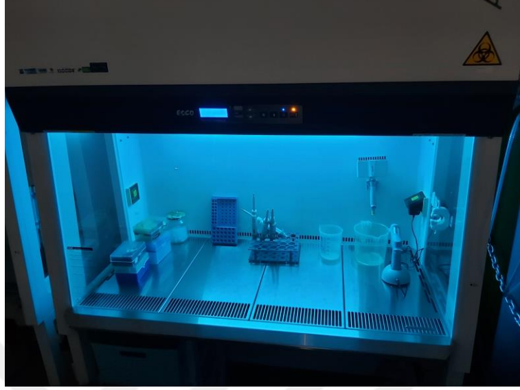
Şekil 3. 9 : UV ile Sterilizasyon
