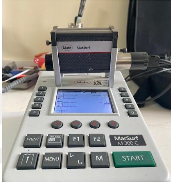
Şekil 3.14: Konvansiyonel profilometre cihazı.
